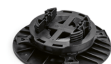
Pedestal ajustável Regulação: 35 a 55mm Consumo: 3,33pedestais por m² Ref#: 1181
