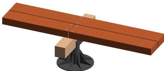
Figure 1 – Principe de pose du lambourdage simple
